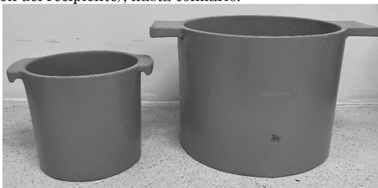
Fig. 13. Recipientes de medida para ensayo de densidad bulk .
